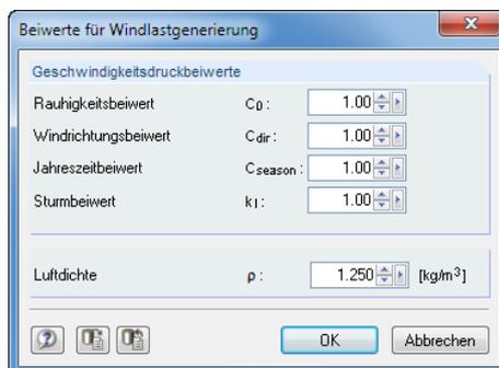
Bild 5.26: Dialog *Beiwerte für Windlastgenerierung* gemäß EN 1991-1-4
