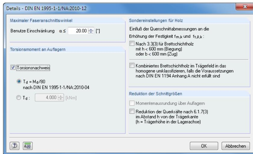
Bild 6.1: Dialog *Details* nach DIN EN 1995-1-1 für RX-HOLZ Brettschichtholzträger
