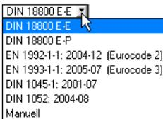
Bei den DIN- und Eurocode-Normen wird der Wert der Schiefstellung  $1/\varphi_0$  automatisch in Spalte E eingetragen.
