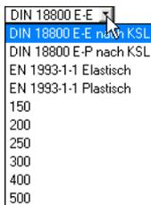
Die Liste enthält die nach den Normen üblichen Werte der Vorkrümmung sowie jeweils zwei Optionen für *DIN 18800* nach KSL (Knickspannungslinie) und *EN 1993-1-1*. Die Vorkrümmungen je nach Knickspannungslinie sind in DIN 18800 Teil 2, Absatz 2.2 beschrieben. Nach EN 1993-1-1 ermittelt sich die Vorkrümmung nach Absatz 5.3.2(3), Tabelle 5.1 ebenfalls in Abhängigkeit von der Knicklinie des Querschnitts.
