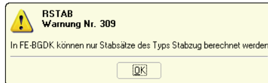
Bild 3.2: Warnung bei Bemessung einer Stabgruppe
