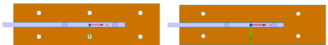
Bild 7.31: Schrauben zwischen jedem Dübel Gleich (links) oder nur für Ränder (rechts)
