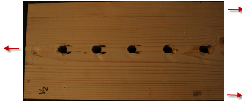
Bild 13.24: Blockscherversagen (Quelle: Tragfähigkeit von Brettsperrholz ; H.J. Blaß, T. Uibel)
