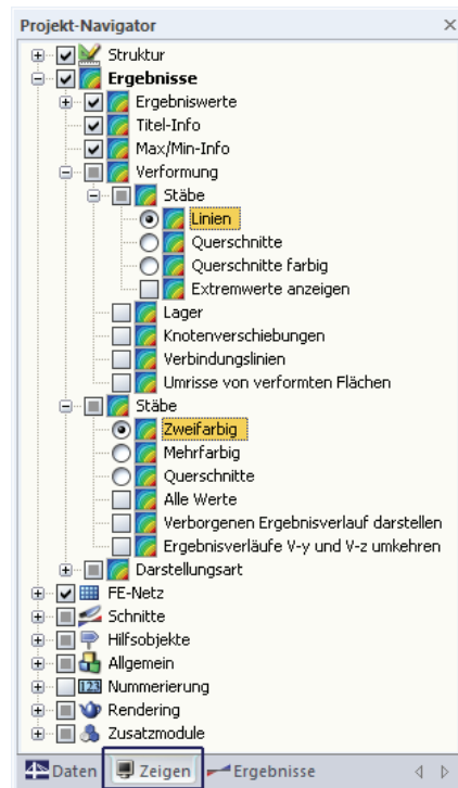
Bild 6.6: Zeigen-Navigator: Ergebnisse → Verformung / Stäbe
