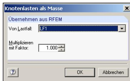
Bild 3.5: Dialog zur Auswahl eines Lastfalls und Faktors für die Zusatzmassen
