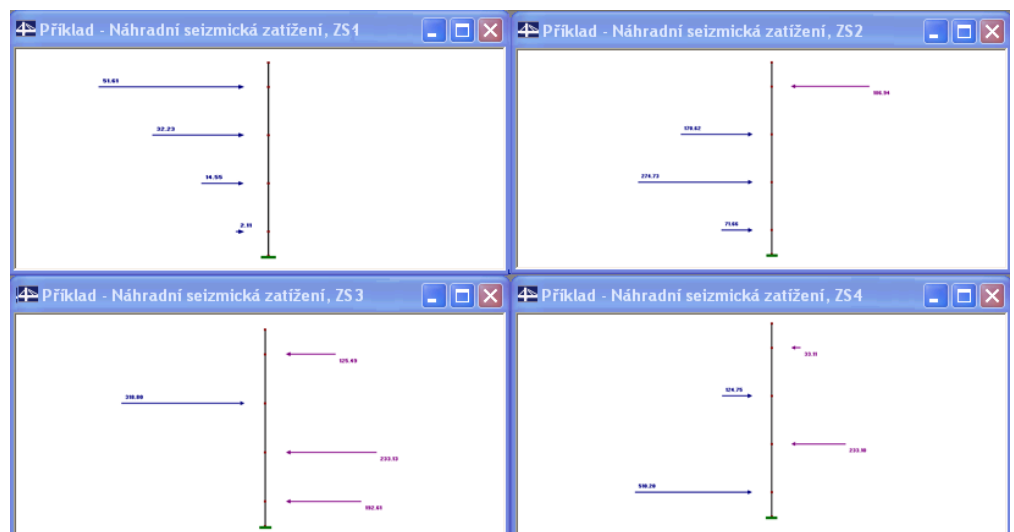
Obr. 6.14: Grafické zobrazení exportovaných náhradních zatěžovacích stavů 1 až 4
